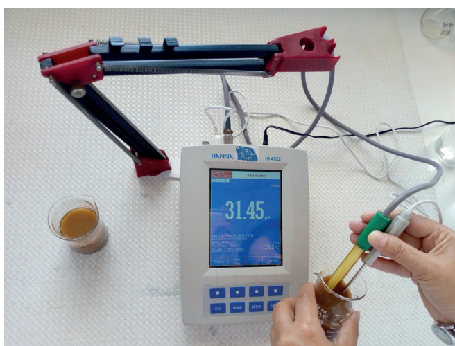
Slika 20. Mjerenje elektrolitičke provodljivosti u vodenoj suspenziji zemljišta
