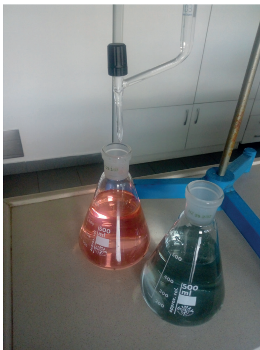
Slika 38. Određivanje azota u đubrivu (prije i nakon titracije sa standardnim rastvorom NaOH)
