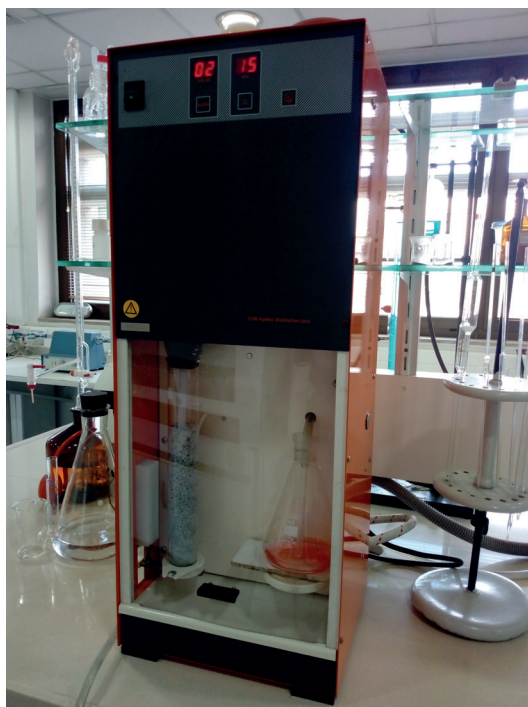
Slika 37. Destilacija azota iz amonijum nitatnog đubriva
