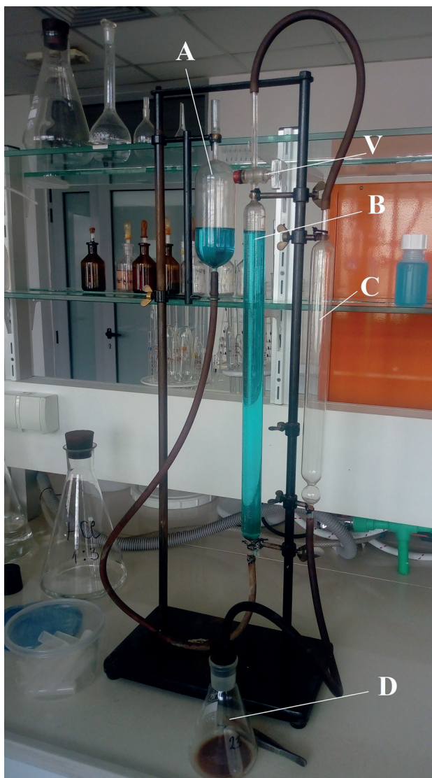
Slika 22. Kvantitativno određivanje ukupnih karbonata u zemljištu pomoću Šajble-rovog kalcimetra: A – pokretna cijev, B – graduisana cijev, C – cijev, D – erlenmajer u kome se nalazi uzorak, V – ventil tj. slavina
