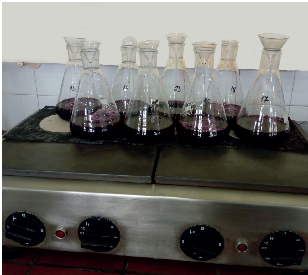
Slika 24. Serija uzoraka zemljišta sa dodatim rastvorom \text{KMnO}_4 u fazi ključanja kod određivanja humusa
