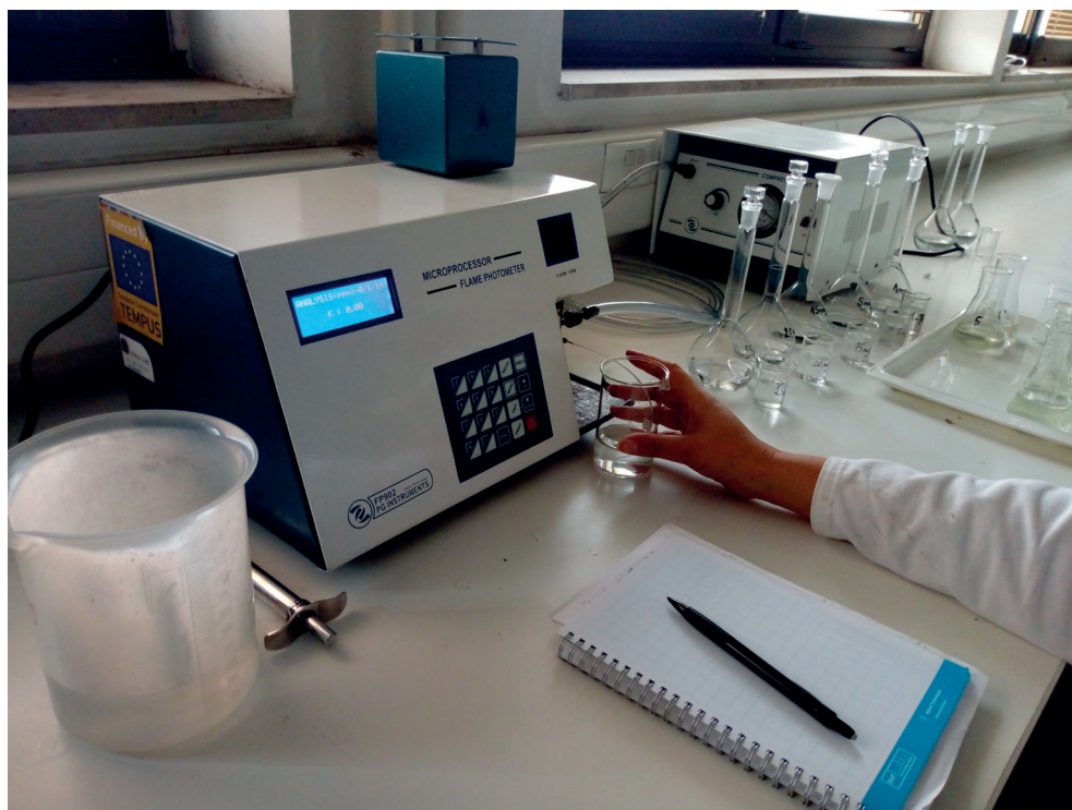
Slika 32. Određivanje koncentracije pristupačnog kalijuma u zemljištu na plamenom fotometru
