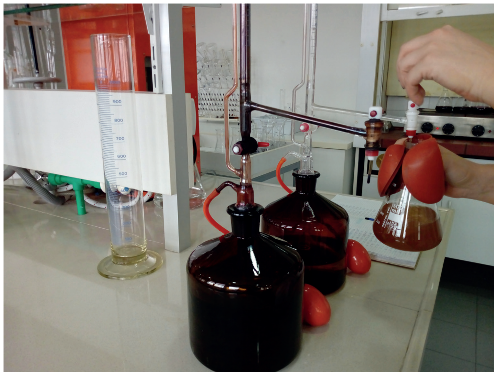
Slika 25. Titracija sa rastvorom oksalne kiseline kod određivanja humusa
