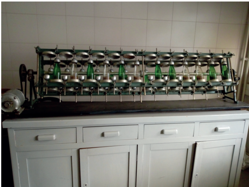
Slika 28. Rotaciona mućkalica za ekstrakciju većih uzoraka zemljišta i drugih čvrstih materijala
